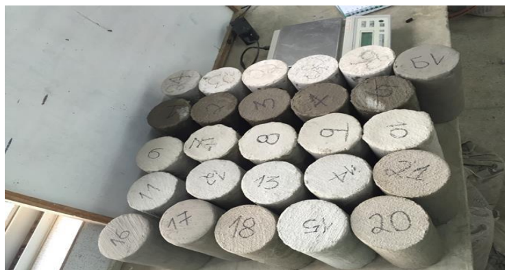
Figura 2. Corpos de prova com aplicação dos produtos A, B, C e referência.
