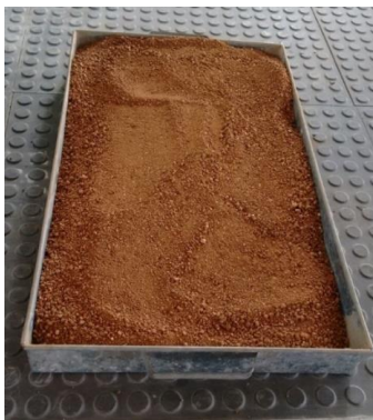
Figura 1. Material passante na peneira 4,8mm – solo.
