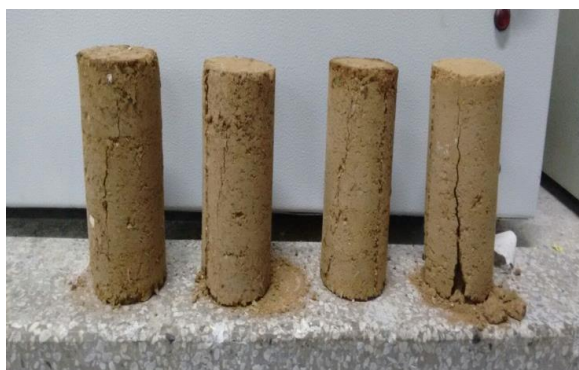
Figura 6. Amostras fissuradas (10, 7, 5% PET e solo-cimento, respectivamente).
