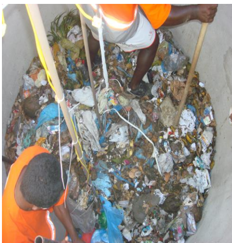
Figura 5. Preenchimento da célula experimental com o RSU.
