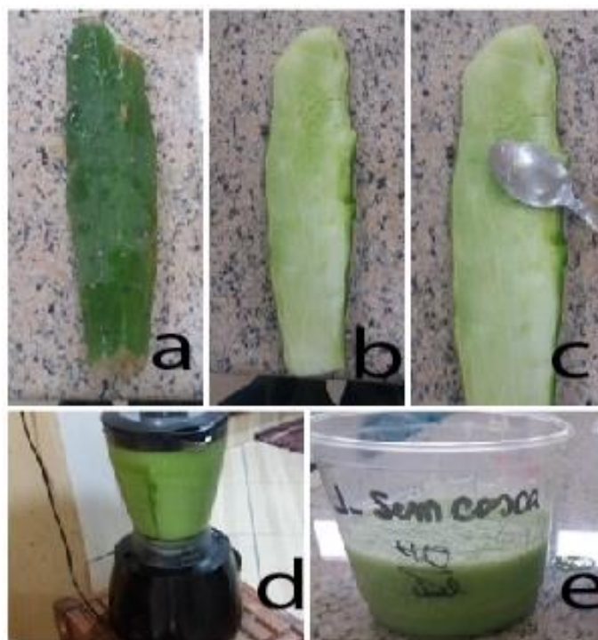
Figura 2. a) Palma do cactus Opuntia cochenillifera , b) Retirada de espinhos e casca, c) Raspagem do interior, d) liquidificação, e) Resultado final do coagulante após peneiramento.
