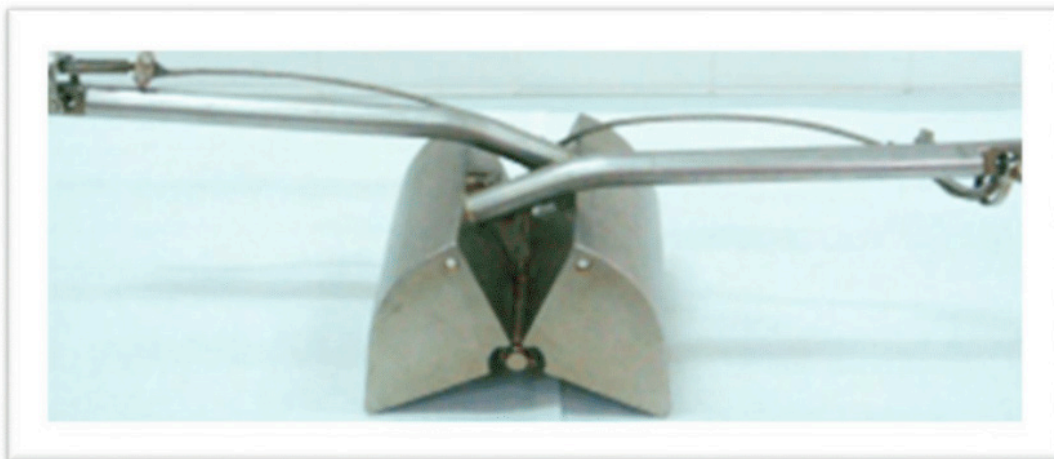
Figura 4. Apresentação da estrutura do Amostrador Van Veen.
