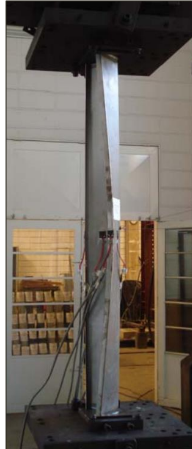
Instabilidade por Flexo-Torção Fonte: MAIA (2008)
