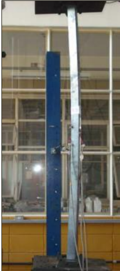
Instabilidade por Flexão Fonte: MAIA (2008)
