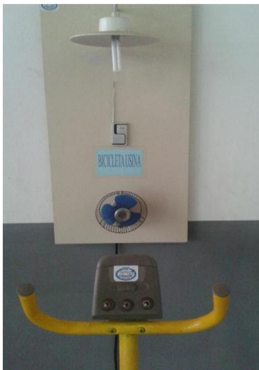
**Objetivo:** demonstrar a geração da eletricidade através de um sistema que transforma a energia mecânica em elétrica, a partir do pedalar de uma bicicleta.
