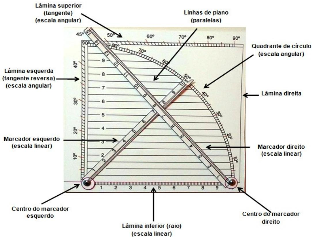
O princípio do funcionamento desse instrumento são as representações de triângulos, razão pela qual o setor recebe seu nome, isto é, "trigonal" no sentido de que os dois marcadores móveis podem ser ajustados para formar três ângulos (DIAS; SAITO, 2014).
