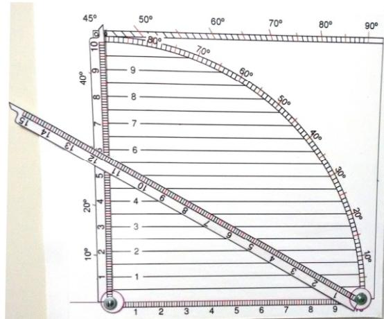
Se considerarmos o raio do instrumento sendo dividido em 10 partes, teremos a medida da tangente de  $30^\circ$  igual a 5,7 partes e a medida da secante como 11,5 partes. Fazendo a proporção do raio em 100, teremos 57 partes para a tangente e 115 partes para a secante. Destacamos aqui o potencial didático de trabalhar com as proporções.
