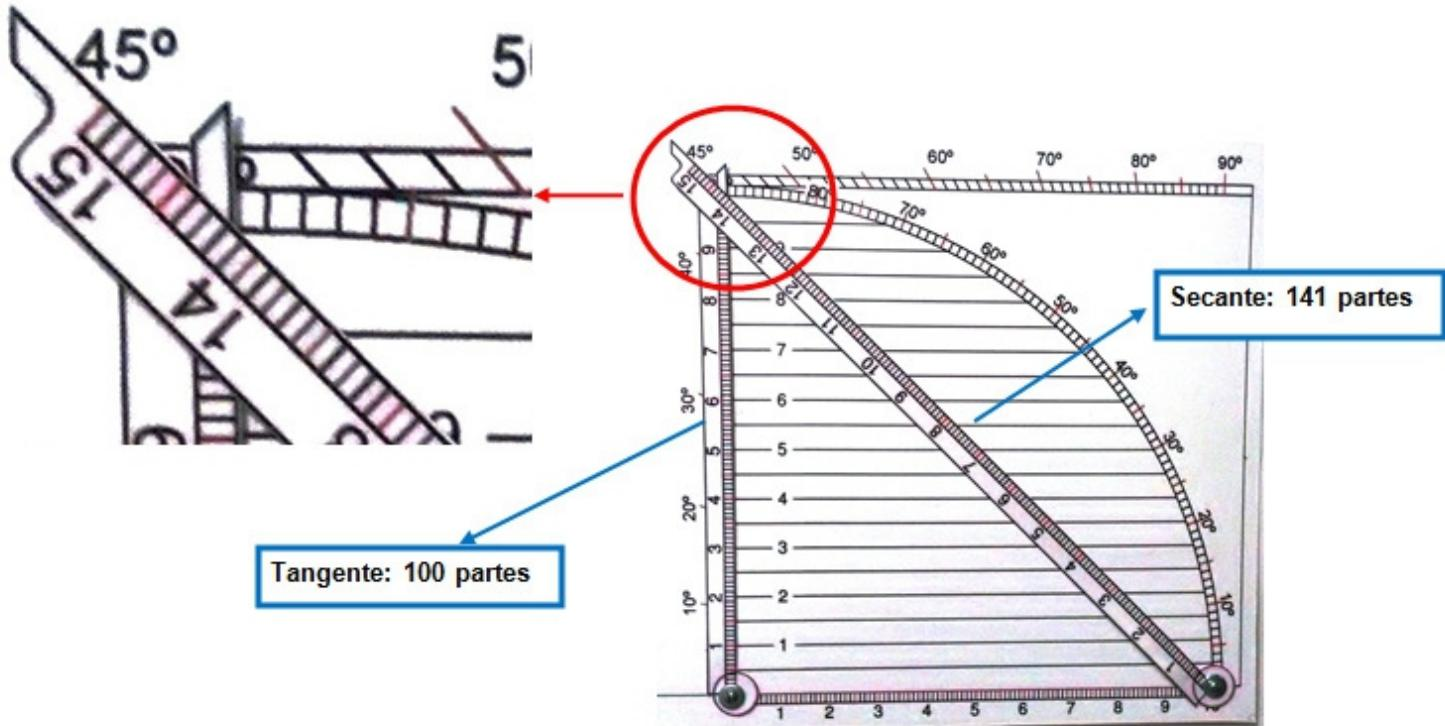
O autor utiliza a escala linear, conforme convém, unidade ou subunidades. Sendo assim, o raio do instrumento pode ser dividido em 10 partes ou 100 partes.
