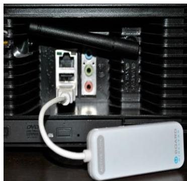
*A conexão da Lousa Digital ao Projetor Interativo é feita por meio da porta USB. Nela, é conectado o transmissor sem fio que é responsável pela comunicação entre o computador e a Lousa Digital.*
