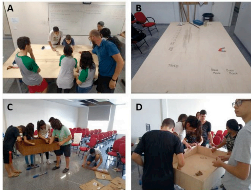
Figura 1 – Etapas de planificação e montagem da estrutura da mesa. A: planificação da estrutura, B: plano da mesa planificado, C: envernizamento do tampo da mesa e D: lixamento da estrutura da mesa.
