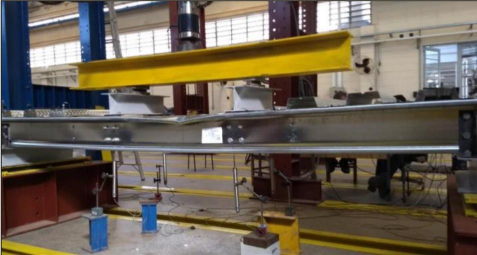
**Instabilidade por Distorção (na flexão)**
