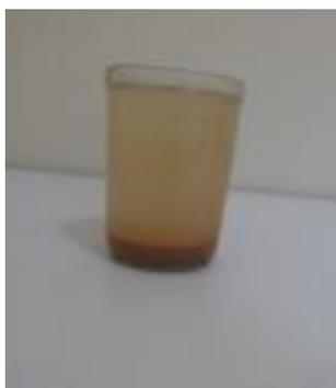
Figura 4 – Copo de água com barro após o repouso.
