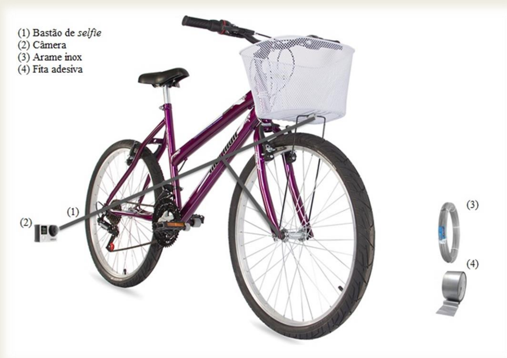
Figura 11 – Materiais utilizados e esquema de acoplamento do bastão de selfie .
