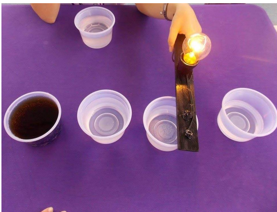
Figura 1 – Diferentes soluções utilizadas para realização da atividade, demonstrando a eletrocondutividade delas. A primeira solução trata-se de um refrigerante de cola, as outras são a base de água com variações de concentração de sais.
