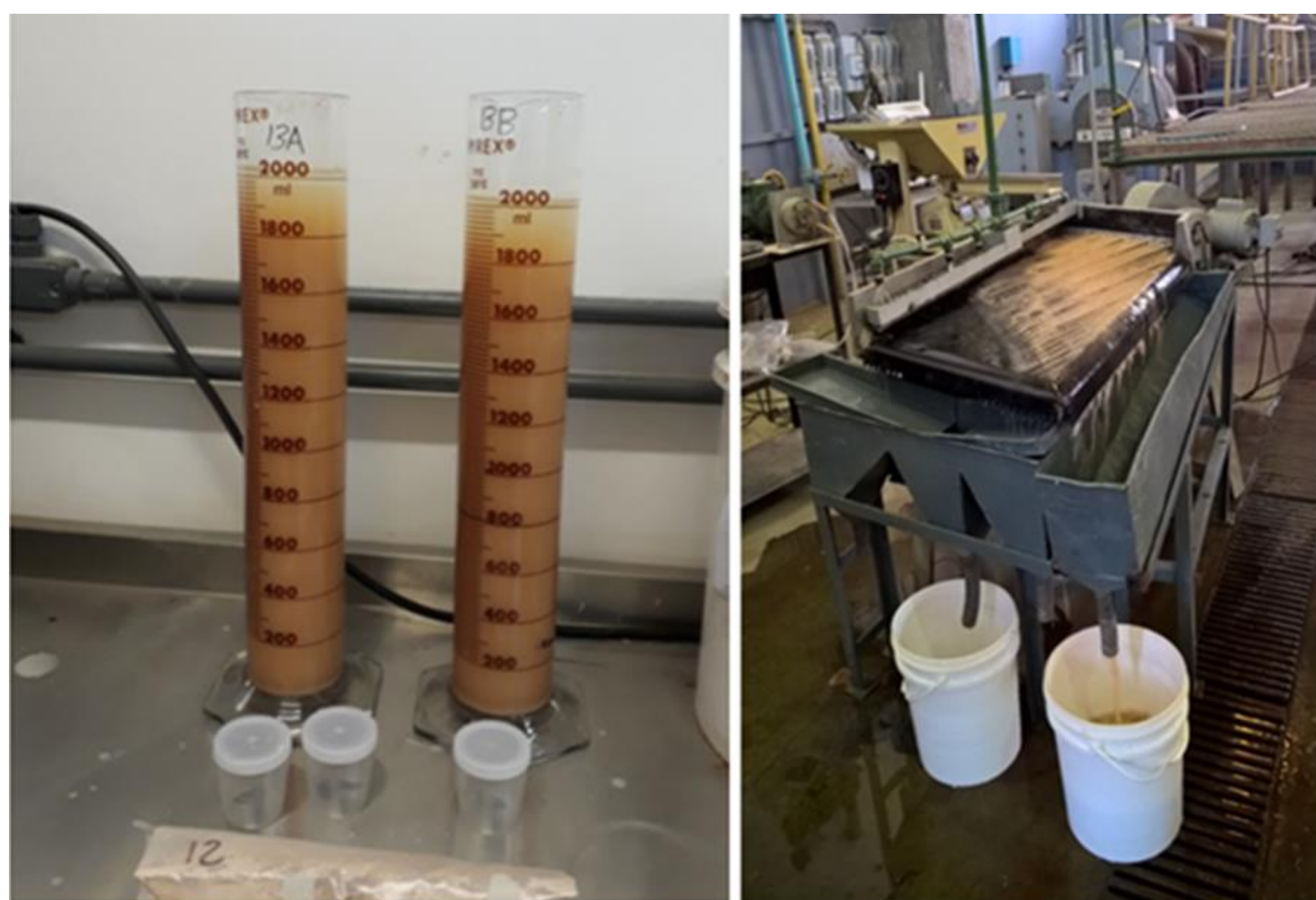
Figura 1: Separador por sedimentação em bancada e separador por mesa vibratória
