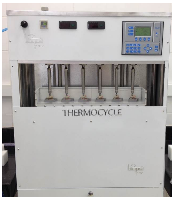
Figura 9 – Máquina para testes de fadiga por ciclagem mecânica.
