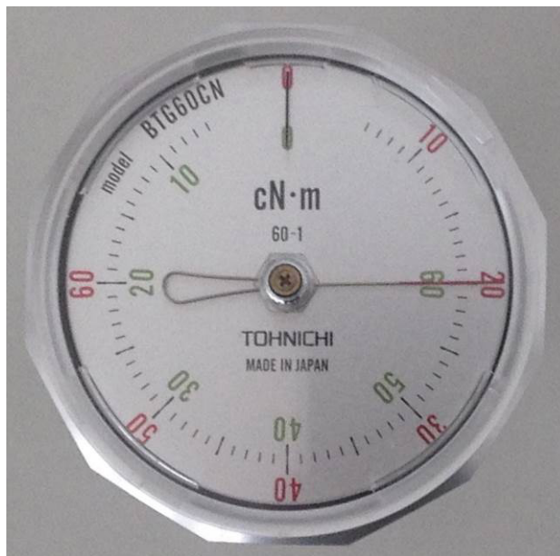
Figura 7 – Torquímetro acionado até 20N.cm.
