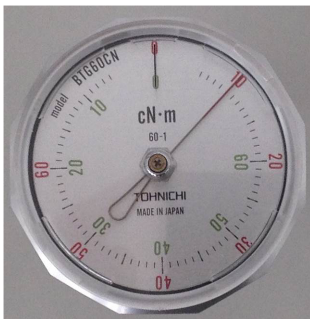
Figura 8 – Torquímetro acionado até 10N.cm.
