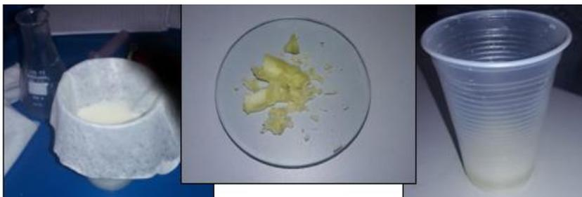
Da direita para a esquerda: filtrando a albumina do Leite Materno, albumina filtrada e Leite Materno após filtração. Fonte: Arquivos da autora (2018).
