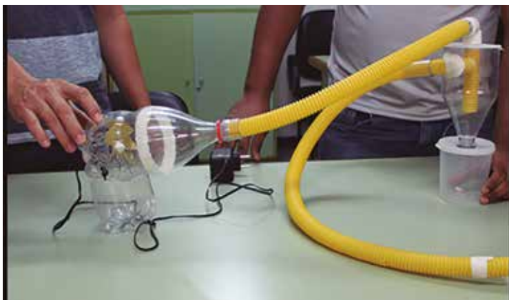
Figura 17 - Conexão do coletor Underflow na conexão do motor
