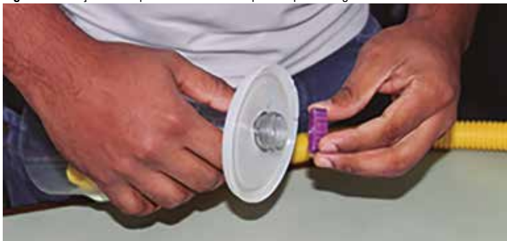
Figura 11- Fixação do tampo do reservatório na parte superior da garrafa PET
