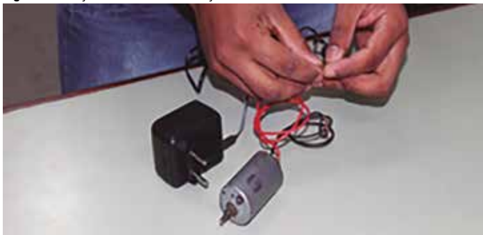
Figura 9 - Fixação do cabo de alimentação ao motor
