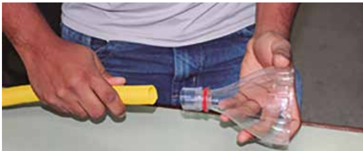
Figura 13 - Conexão da extremidade superior o funil do PET, fazendo uso de uma mangueira polimérica
