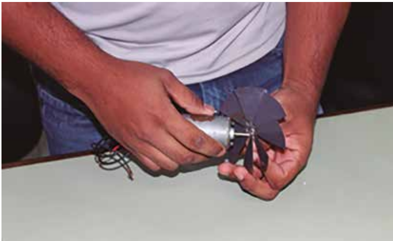
Figura 8 - Acoplamento da pá da hélice no motor
