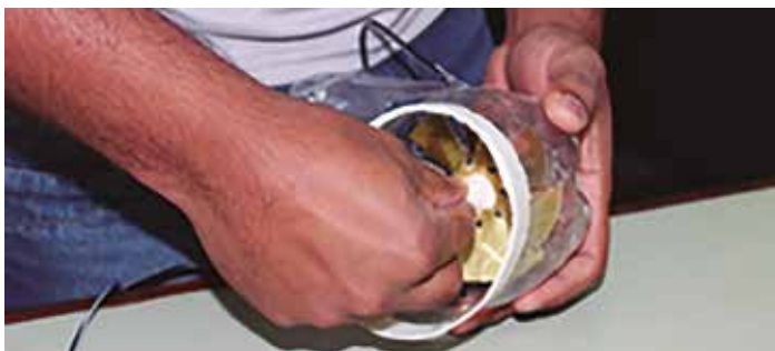
Figura 10 - Fixação do conjunto motor-hélice com durepox e do conjunto Motor-hélice com a base da garrafa PET
