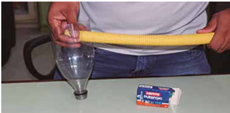
Figura 15 - Conexão de um conduíte de 85 cm a lateral da garrafa PET
