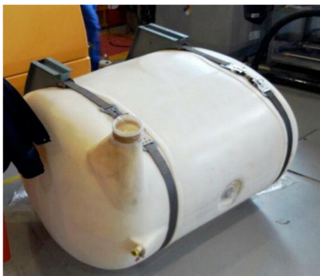
Figura 7 : Tanque original do helicóptero Esquilo AS350
