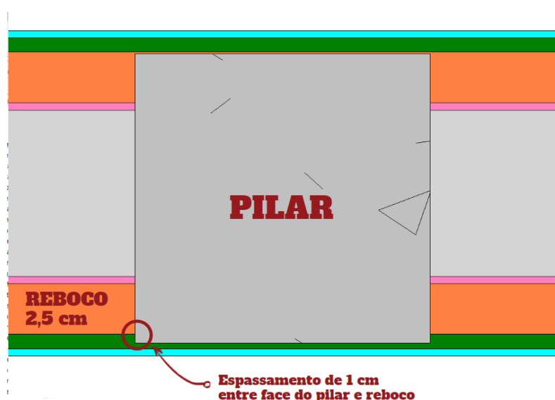
Figura 4 - Desaprumo entre pilar e reboco 2,5 cm.
