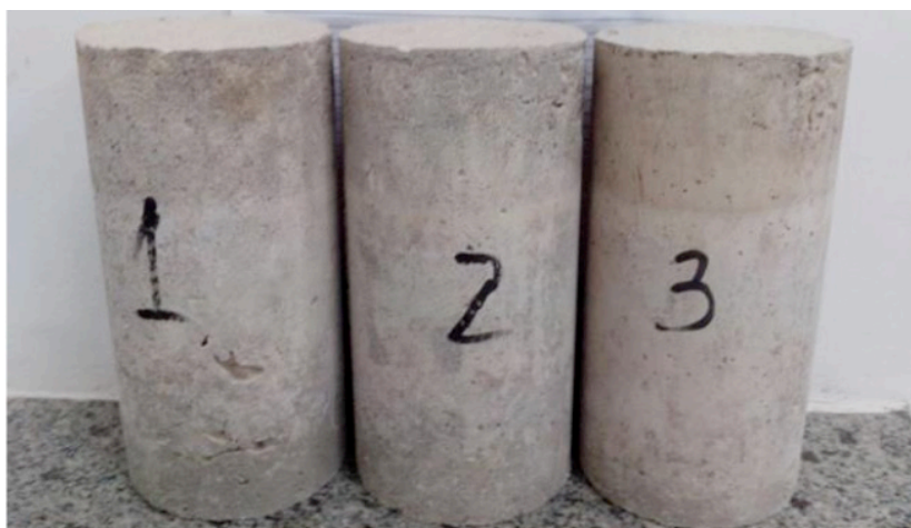
Figura 2 - Efeito da eflorescência nos corpos de prova
