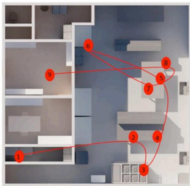
Figura 1: Diagrama espaguete do fluxo do processo antigo.
