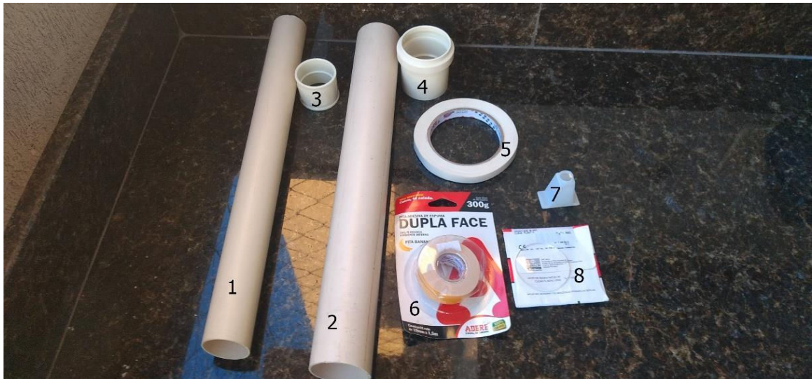
Imagem 14: Material usado na construção da luneta. Fonte: Próprio Autor.
