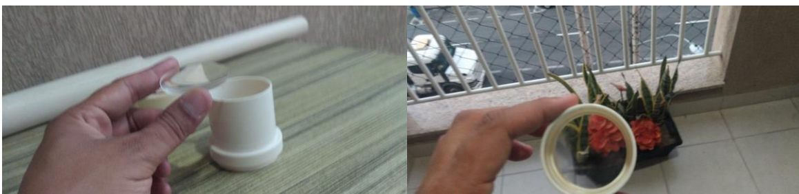
Imagem 21: Encaixando a lente objetiva na luva de 50mm. Fonte: Próprio Autor.
