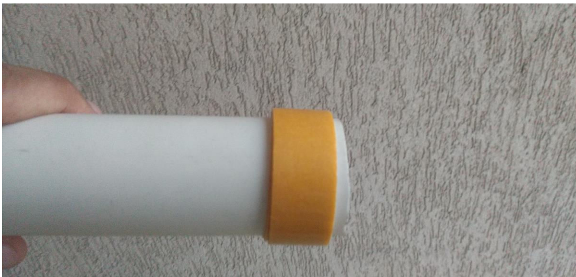
Imagem 16: Fita esponjosa colada por fora do cano de menor diâmetro. Fonte: Próprio Autor.
