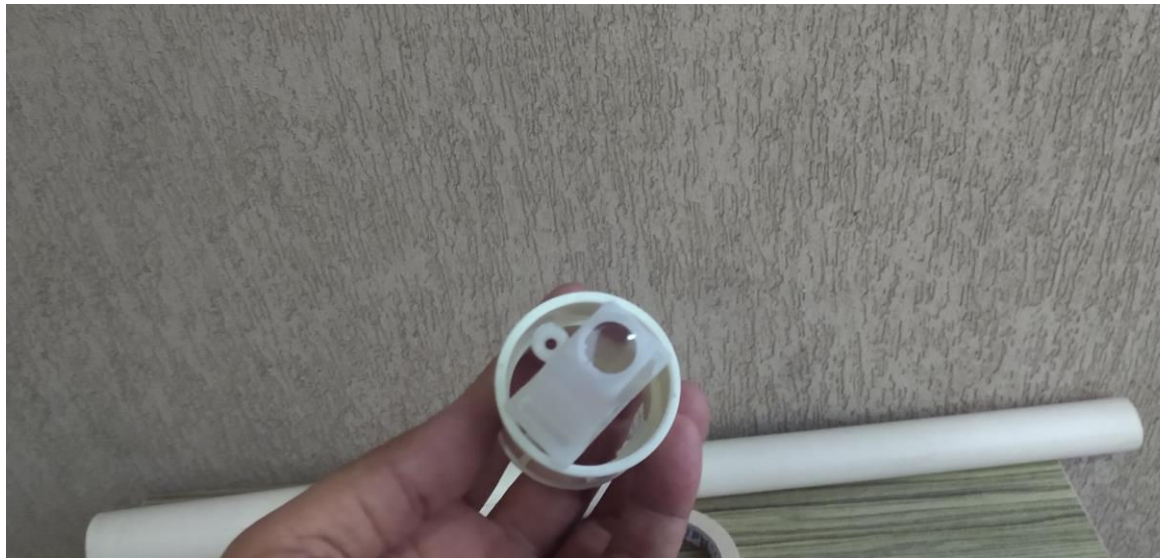
Imagem 19: Monóculo encaixado à luva de 40mm. Fonte: Próprio Autor.
