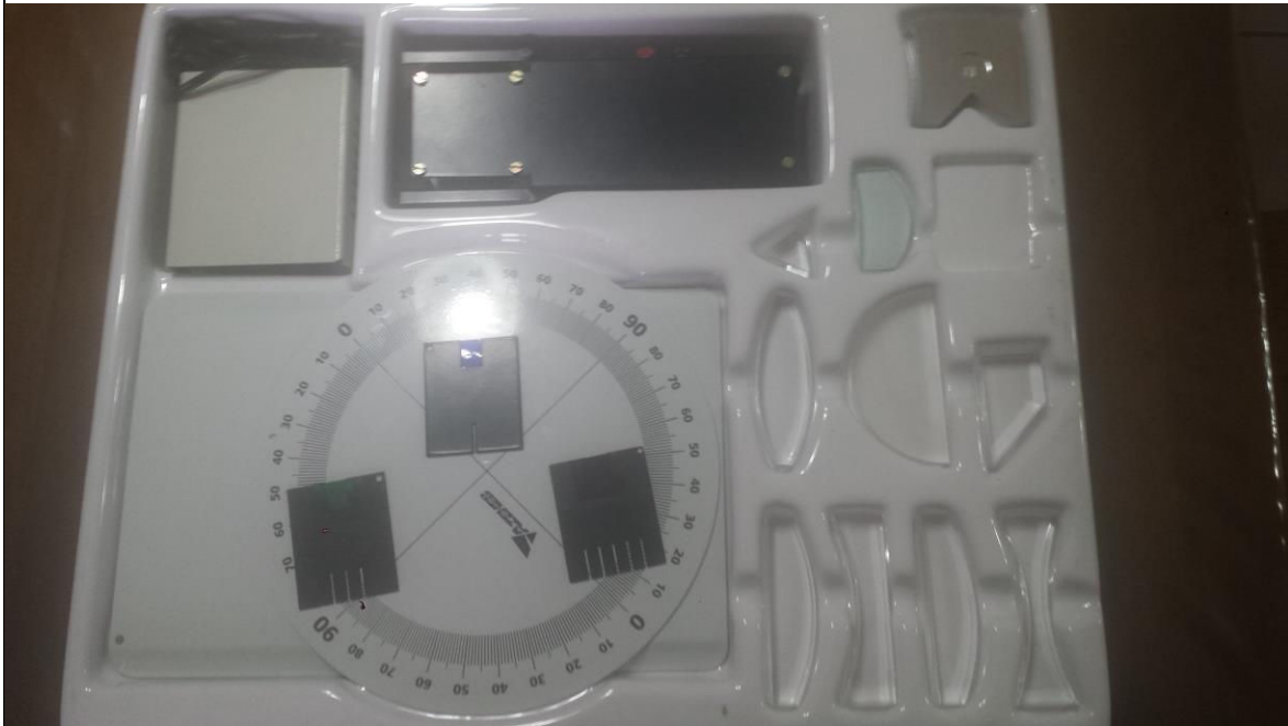
Imagem 3: Conjunto óptico utilizado na aula. Fonte: Próprio autor.
