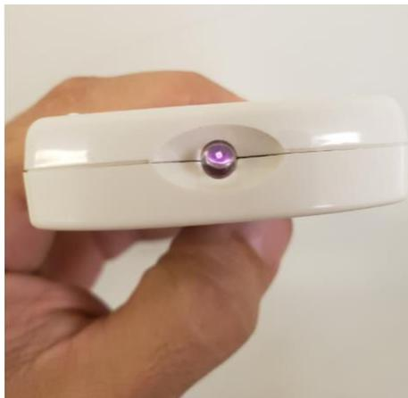
Figura 19: Foto tirada do controle do ar condicionado ao emitir radiação infravermelho. Fonte: o autor.
