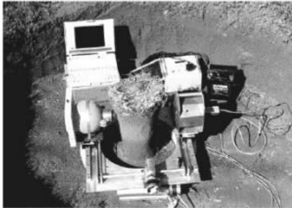
Figura 2: Tomógrafo instalado em torno de um monólito de solo
