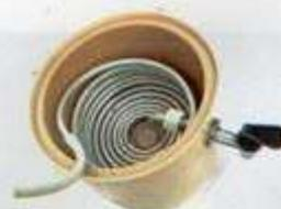
Figura 27: Foto de serpentina de resfriamento, neste caso, utilizada para gelar a água de coco.
