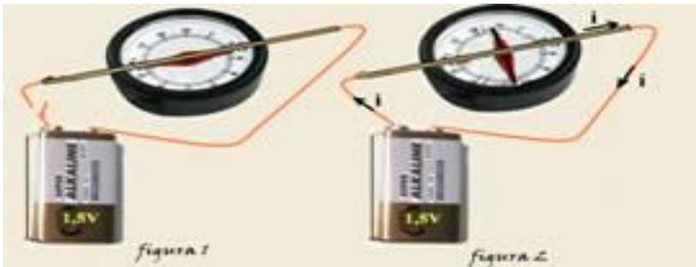
Ao ligar as extremidades do fio condutor a uma pilha, por onde passa uma corrente, a agulha muda de direção, conforme figura 2. Com base neste experimento, é correto afirmar que
