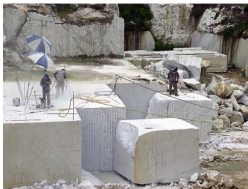
Figura 6: Extração de blocos na pedreira
