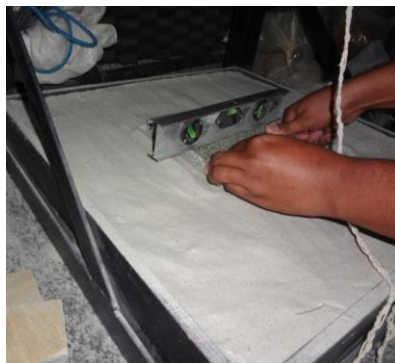
Figura 23 - Nivelamento do corpo de prova
