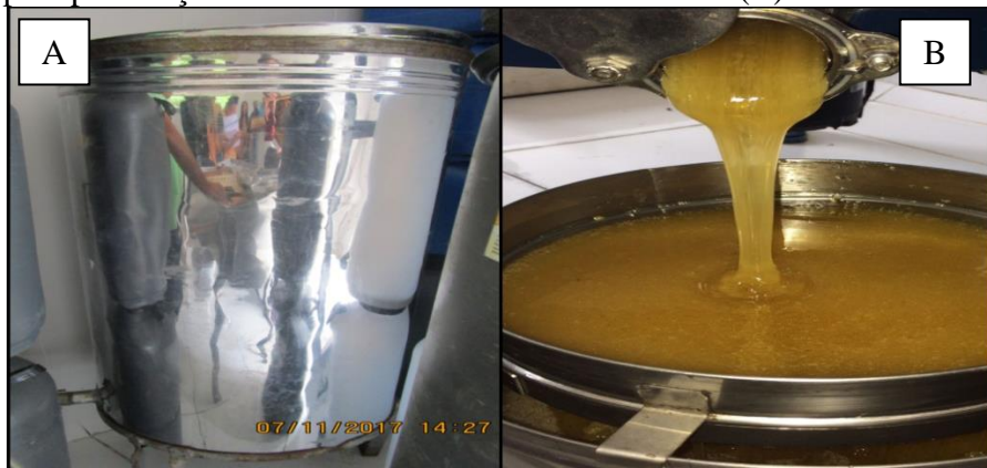
Figura 29 – Decantador (A) e mel escoando da centrifuga, passando pela peneiração e sendo armazenado no decantador (B).
