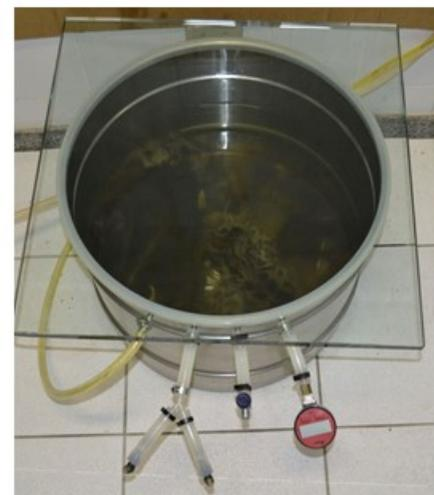
**Câmara de vácuo em temperatura ambiente. Impregnação forçada com polímero silicone.**
