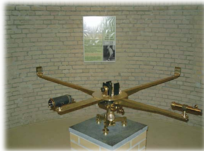
Figura 24: foto de um aparato experimental semelhante ao usado por Michelson e Morley entre os anos 1881 e 1887.
