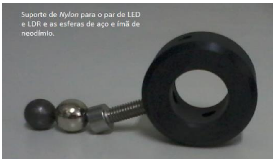
FIGURA 36 – Suporte de nylon e esferas de aço e de neodímio.
