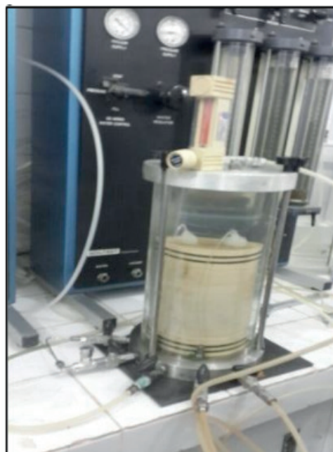
Figura 2 - Câmara de Fluxo com rotâmetro
