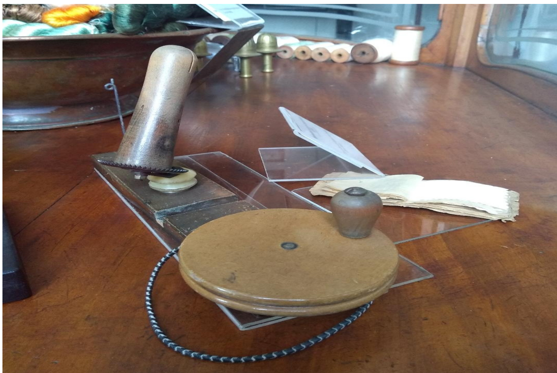
Imagem 2: Máquina de envolver e torcer meadas de seda
