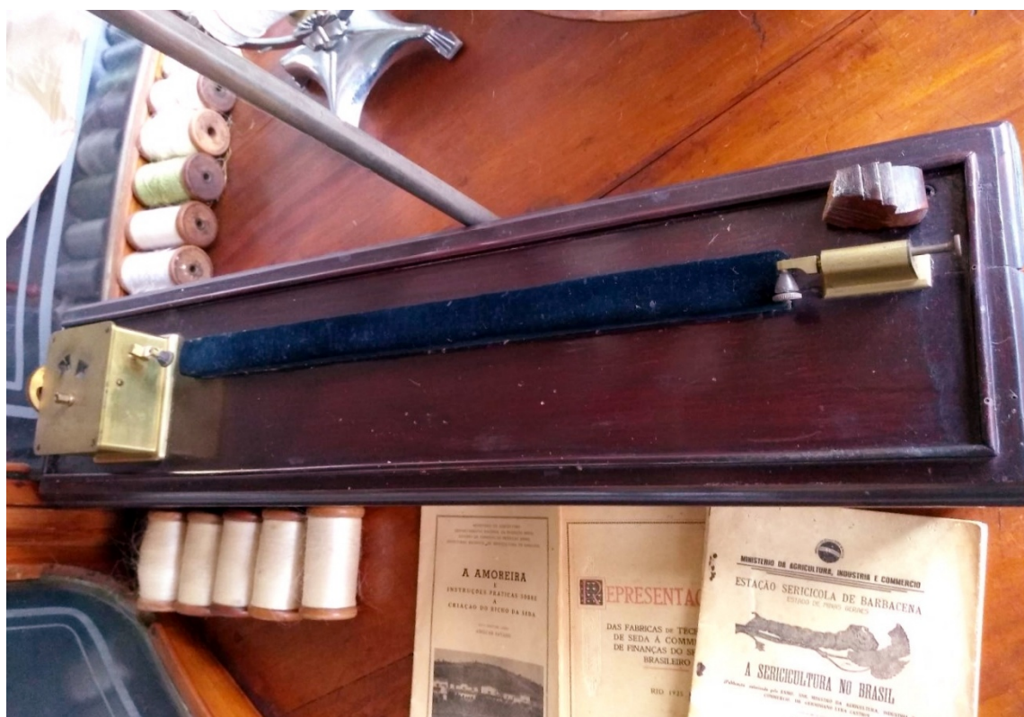
Imagem 4: Aparelho para medir metragem de carretéis
