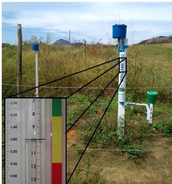
**Figura 5** – Irrigômetro utilizado no manejo da irrigação.
