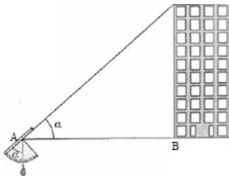
Sabendo o valor desse ângulo (o ângulo  $\alpha$ ) e a medida da distância do observador ao objeto a ser medido (segmento AB), faz-se o desenho de um triângulo retângulo com as medidas e, a partir das razões trigonométricas no triângulo retângulo, calcula-se a medida que se quer achar, que, no caso, é a altura de um prédio, conforme desenho:
