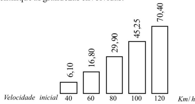
De acordo com esse gráfico, podemos dizer que o espaço necessário para um automóvel parar é uma função da velocidade que ele tem, quando começa a frenagem. A 40 km/h são necessários 6,10 m, a 80 km/h necessita-se de 29,90 m.
