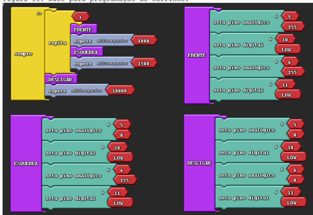
Figura 13: Base para programação do carrinho.
