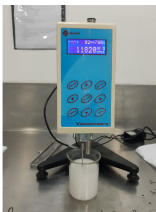
Figura 3: Teste de viscosidade realizado com as amostras de sabonetes líquidos íntimos.
