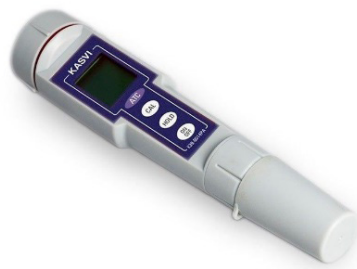
Figura 2: Modelo de pHmetro utilizado para identificar o pH das amostras de sabonetes líquidos íntimos.
