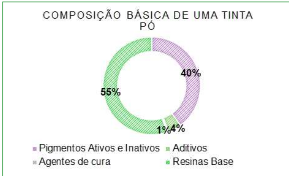
Figura 3: Composição Básica de uma Tinta Pó
