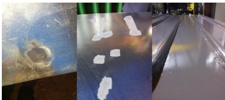
Figura 6 - Modelo do tipo chapa-tubo após receber aplicação de pasta térmica, polimento e tinta anti-corrosiva (SILVA et al., 2018b).
