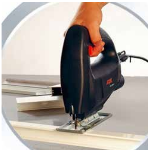
Figura 52 – Serra elétrica Tico tico – Oferece possibilidade de corte de madeira de até 65mm – excelente para trabalhar com MDF.
