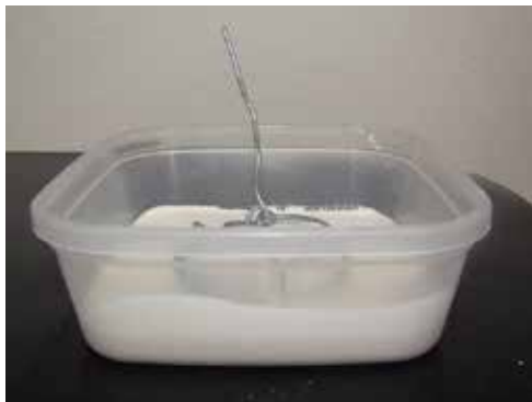
Figura 56 – Coloca-se o arame dentro de um recipiente que será preenchido com gesso.
