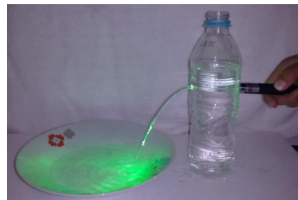
Figura 8. Realização da experiência reflexão da luz com fibra óptica caseira. Foto: Carmem Diehl
