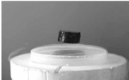
Figura 19 – Uma levitação magnética com um elemento que está com a temperatura abaixo da temperatura de transição, efeito Meissner.
