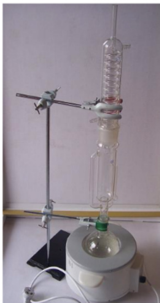
Figura 2. Reprodução de um sistema de extração Soxlet
