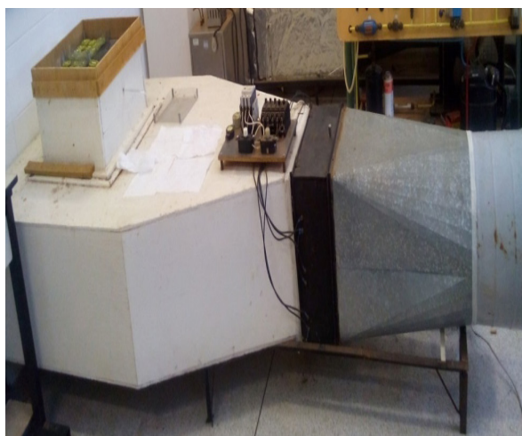
Figura 3 - Secador de leito fixo – imagem real
