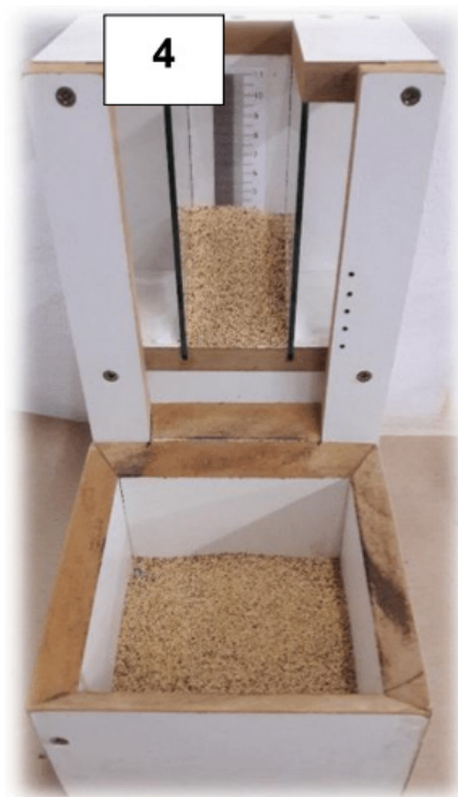
Figura 4. Equipamento utilizado para encontrar o ângulo de repouso.
