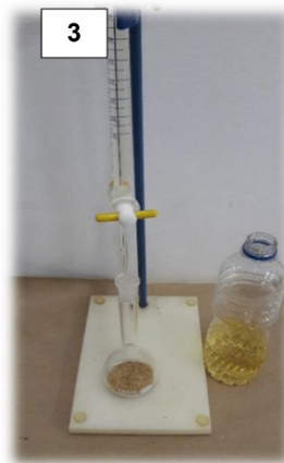
Figura 3. Bureta graduada, óleo de soja e balão volumétrico, usados para encontrar a massa específica real dos grãos de quinoa e amaranto.
