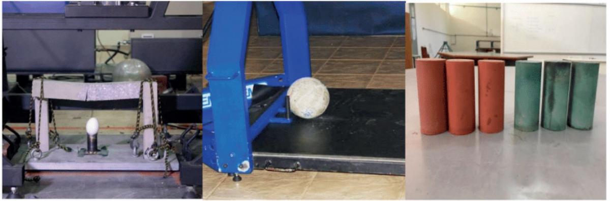
Figura 1a - Aparato de proteção ao ovo. Figura 1b - Concreto em formato esférico. Figura 1c - Concreto colorido de alta resistência
