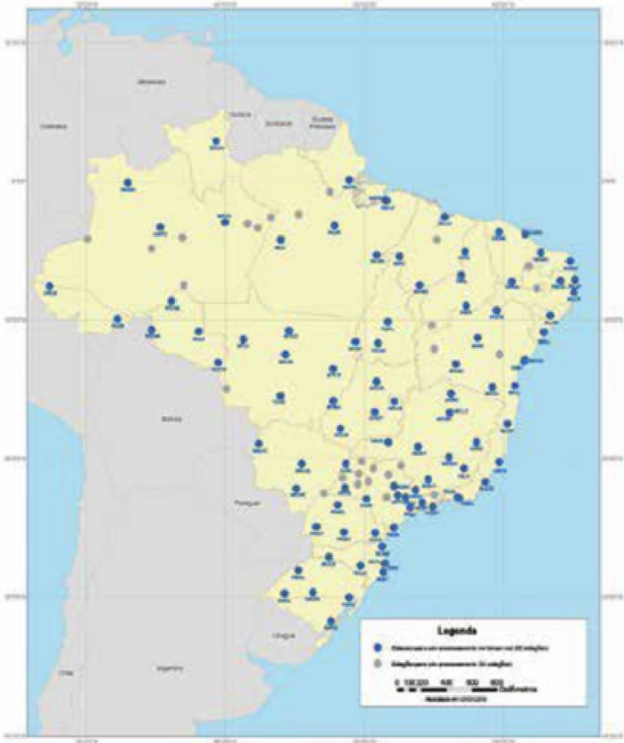
Figura 5.13: O posicionamento do GPS pode ser corrigido pelo sistema relativo estático (estação de RBMC). O IBGE lançou um serviço gratuito, chamado RBMC-IP, que permite que usuários de equipamentos de GPS, com acesso à Internet sem fio, obtenham coordenadas (latitude, longitude e altitude) em tempo real. Página: 146
