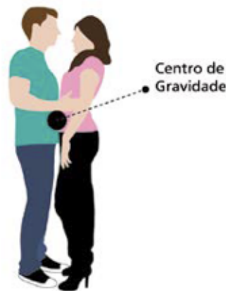
Figura 2.7: A figura mostra dois corpos, cada um com seus centros de gravidade. Quando juntamos dois corpos ou mais, temos de definir um novo centro de gravidade, pois agora agregados por alguma força passam a formar um novo corpo (ou conjunto). Página: 56.
