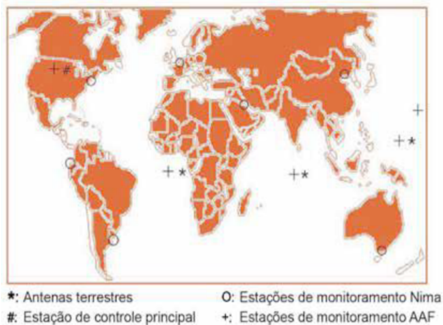
Figura 5.4: Segmento de controle – estações terrestres para envio e transmissão de dados para os satélites e, destes, para o receptor de GPS. Página: 133
