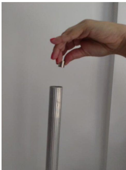
Figura 9 - Ímã abandonado em um tubo de alumínio
