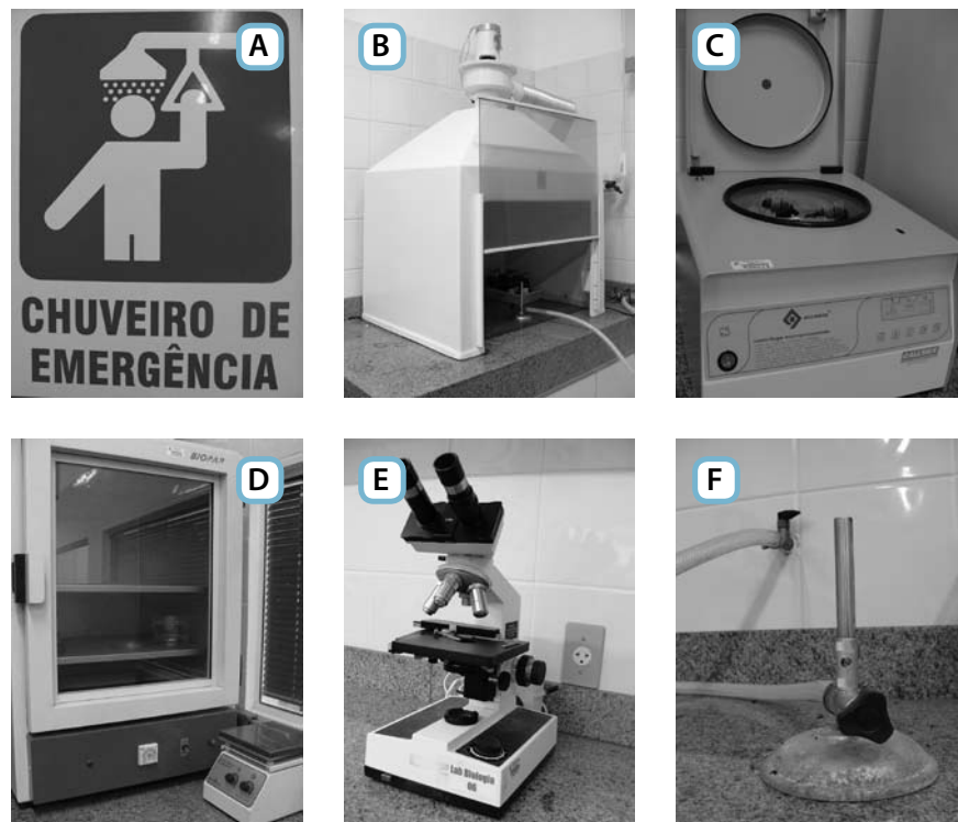
Figura 12 - (A) sinalização de emergência, (B) capela para trabalho com produtos químicos, (C) centrífuga, (D) estufa microbiológica, (E) microscópio óptico binocular (F) tubulação de gás e bico de Bunsen.
