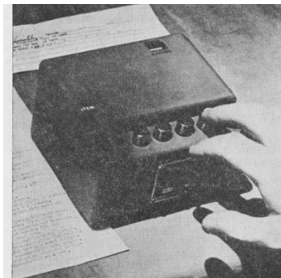
Figura 52: Aparelho de Pressey - máquina utilizada para aplicar testes, avaliar e ensinar. A máquina efetuava testes de múltipla escolha nos estudantes, gerando resultados da aprendizagem do estudante ao professor. (FONTE: acervo da UFRGS)
