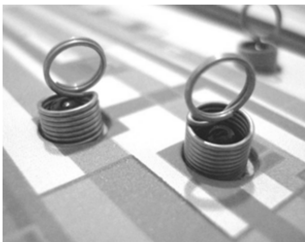
Figura 44: Vista do detalhe dos LEDs inseridos dentro das molas. Fonte: ROSA, 2008, p. 81
