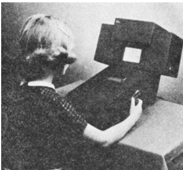
Figura 51: Máquina de ensinar ortografia e aritmética. Para cada acerto o cursor é movido pelo estudante para que execute uma nova questão. Caso este não acerte a resposta deve tentar novamente respondê-la. (FONTE: acervo da UFRGS)
