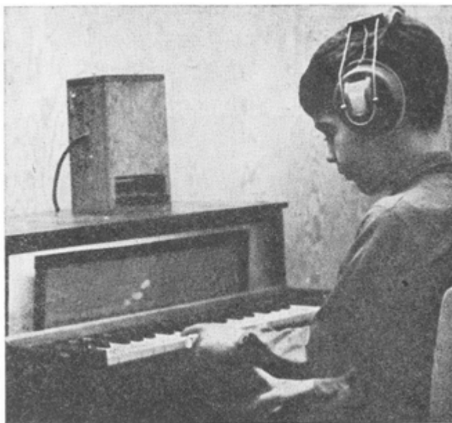
Figura 49: Máquina de ensinar – “pensar musicalmente”. A máquina toca notas isoladas, intervalos, melodias, dentre outros, ao mesmo tempo em que estudante as indica nas teclas. A máquina provê presentes com balas, moedas ou fichas para os acertos dos estudantes. (FONTE: acervo da UFRGS)
