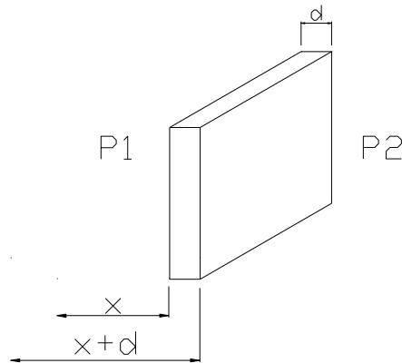
Como a temperatura varia com o tempo, não podemos aplicar a Lei de Fourier. Para superar essa dificuldade, vamos introduzir a grandeza fluxo de calor através de uma seção  $x$ , num instante  $t$ .
