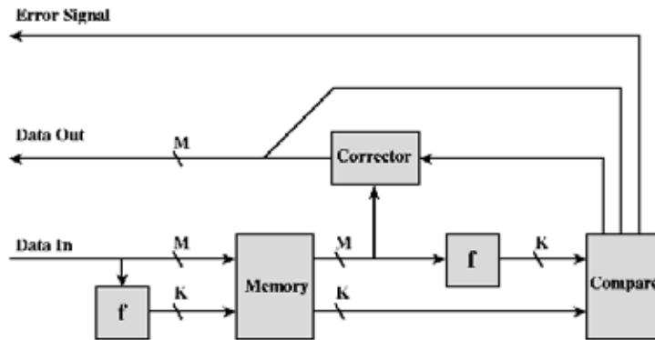
Figura 28 – Mecanismo de correção de erro
