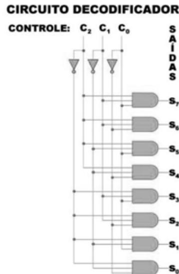
Figura 11 – Diagrama de um Decodificador de 8 saídas com 3 bits de controle
