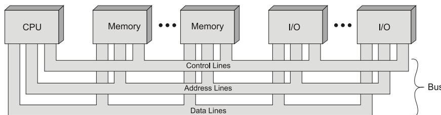
Figura 37 – Diagrama de um barramento único
