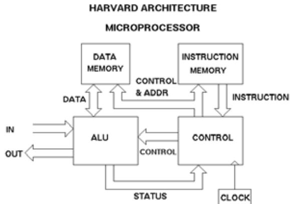
Figura 7 – Diagrama de blocos da Arquitetura Harvard
