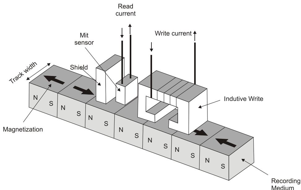
Figura 35 – Funcionamento de uma memória magnética
