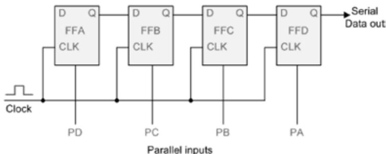
Figura 20 – Registrador de Deslocamento Paralelo-Serial
