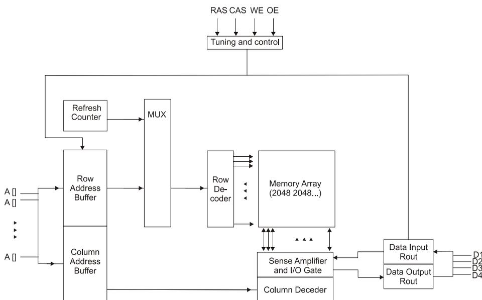
Figura 27 – Diagrama de uma memória RAM dinâmica
