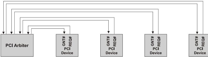
Figura 40 - Arbitragem do barramento PCI
