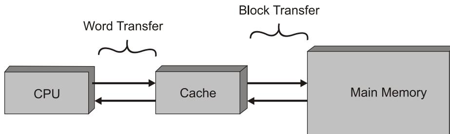
Figura 30 – Diagrama de um computador com memória cache
