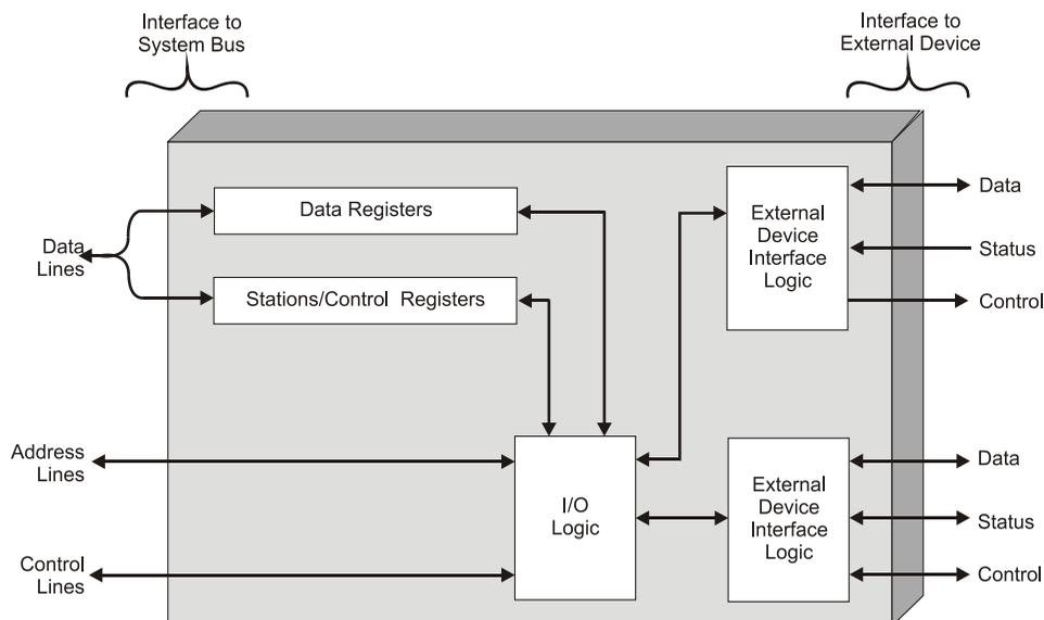
Figura 41 – Diagrama de blocos de um módulo de E/S
