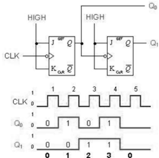
Figura 21 – Contador Assíncrono de 2 bits
