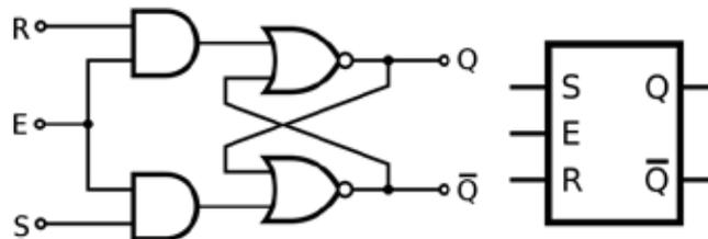
Figura 14 – Flip-Flop SR com Habilitador (relógio)
