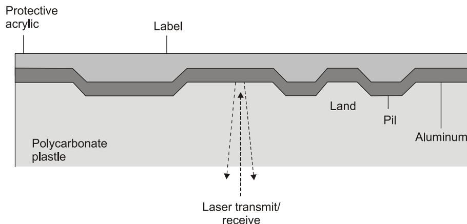
Figura 36 – Funcionamento de uma memória ótica
