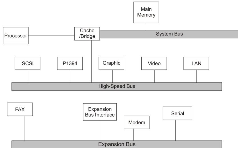
Figura 38 – Diagrama de um barramento múltiplo
