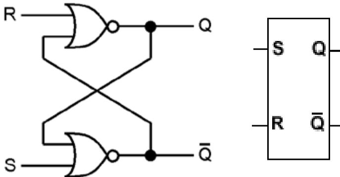
Figura 13 – Diagrama e Símbolo de um Flip-Flop SR
