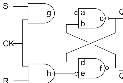
Figura 15 – Flip-flop RS NÃO-E com relógio
