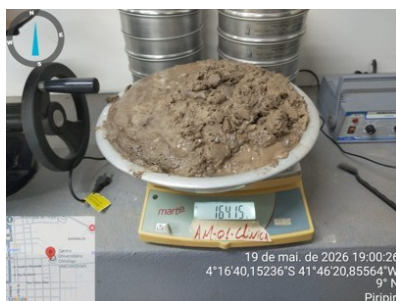
Figura 04 - Pesagem inicial da amostra de solo 01 após coleta.
