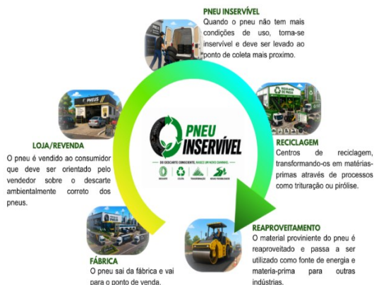
Figura 4 - Processo de Reaproveitamento de Pneus Inservíveis
