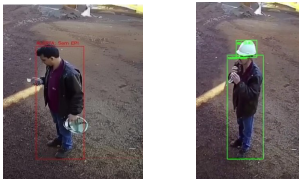
Figura 02 – Detecção em tempo real do uso de EPI's em obra através do uso de IA.
