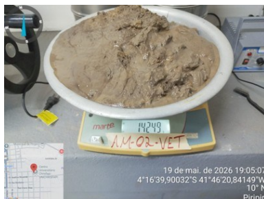
Figura 05 - Pesagem inicial da amostra de solo 02 após coleta.
