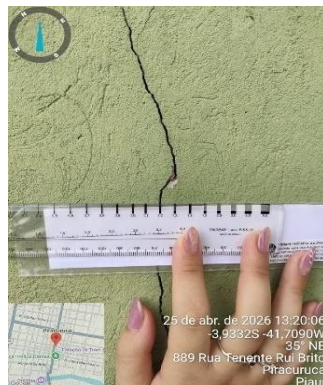
Figuras 24 e 25 – Ensaio com Fissurômetro.
