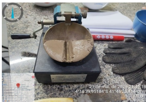
Figura 13 – Execução do ensaio de limite de liquidez no aparelho de Casagrande.
