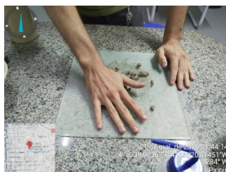
Figura 14 – Execução do ensaio de limite de plasticidade.
