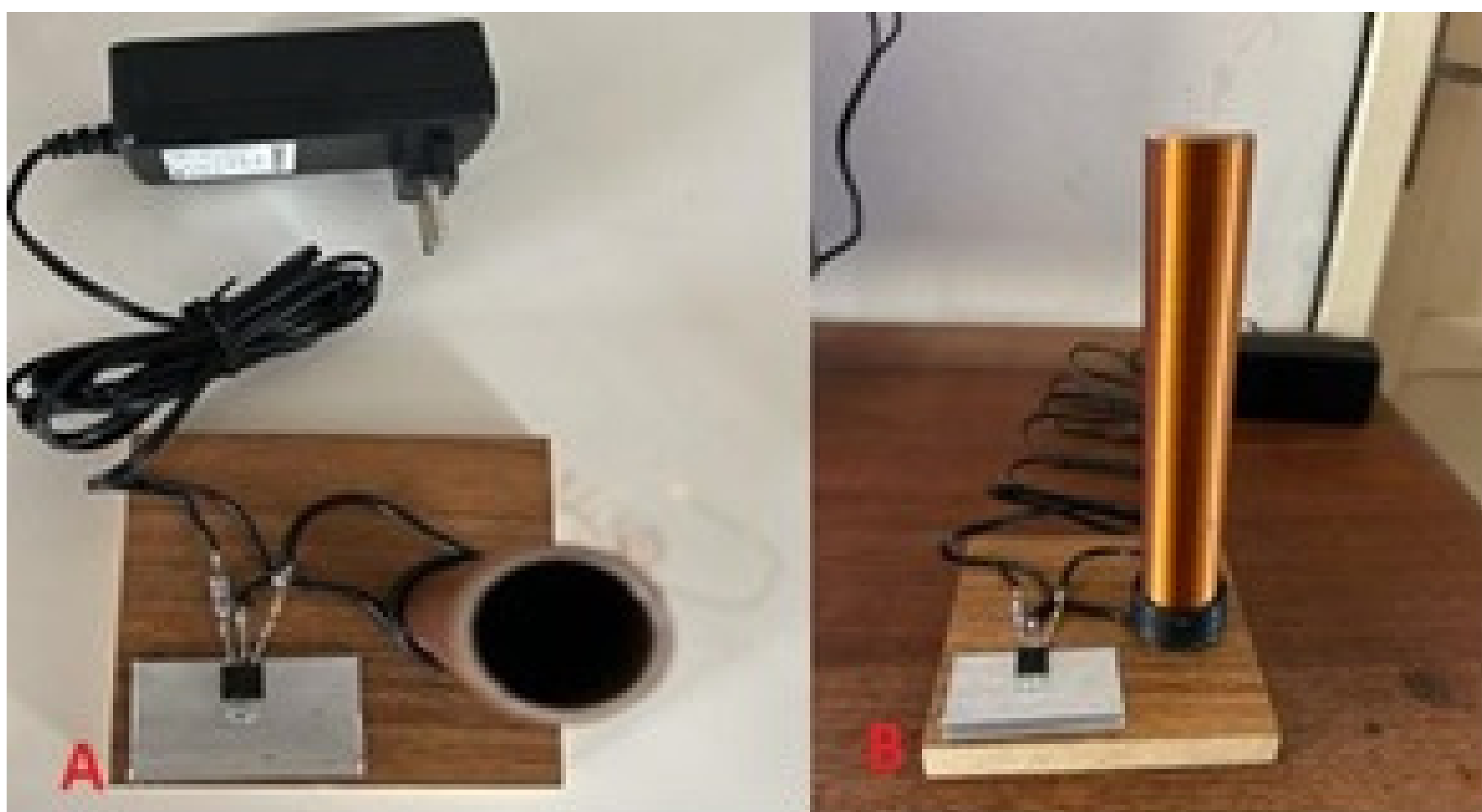
Figura 6 – Imagens da bobina de Tesla de cunho didático
