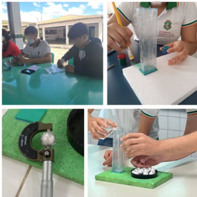
Figura 4 – Construção do modelo físico do recipiente com esferas
